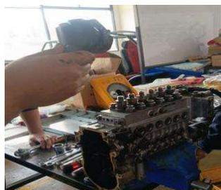
Retiramos los tornillos de la tapa del regulador electrónico con un hexagonal de dado número 5.
