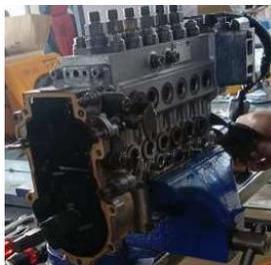
Colocamos el acople siguiendo la guía de la claveta en el eje del variador y ajustamos el perno que posee el acople con la ayuda de una racha y un dado número 30.
